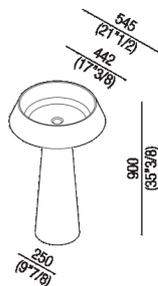
Lavabo in marmo Petit Granit; con bacino cilindrico e appoggio a terra, senza foro per rubinetto, a scarico libero, compreso di kit di fissaggio. Versione per utilizzo a parete, dotata di apertura posteriore per i collegamenti idrici. Entrambe le versioni sono comprese di piletta completa di calotta nella stessa finitura del lavabo (.MET0563).
